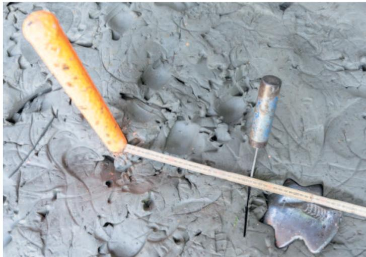
Der Wurf wird mit dem Messstab und dem Messer bewertet.
